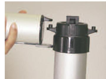
Hängen Sie die Kassette an auf beiden Seiten an den Haken der Teleskopstangen ein und befestigen diese mittels Flügelschraube
