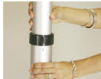
Ziehen Sie die Teleskopstange mittels Drücken/Einrasten des Metallpins auf die gewünschte Höhe
