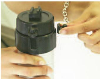
Schieben Sie den Schienenhänger an die gewünschte Position der Teleskopstange
