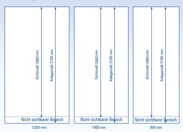
Der "nicht-sichtbare-Bereich" von immer 12cm entsteht durch das Aufrollen der Roll-Ups in der Kassette. Dieser Bereich MUSS mit angelegt werden, da der Roll-Up innerhalb der Kassette befestigt wird. Da diese 12cm Plus/Minus-1cm variieren können empfehlen wir die Hintergrundfarbe des Roll-Up zu verwenden, um ungewünschte "Blitzer" zu vermeiden.
